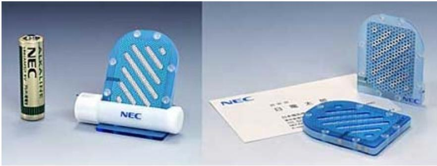
[그림 11] NEC가 탄소나노혼(CNH)를 이용하여 만든 DMFC 연료전지 시작품
