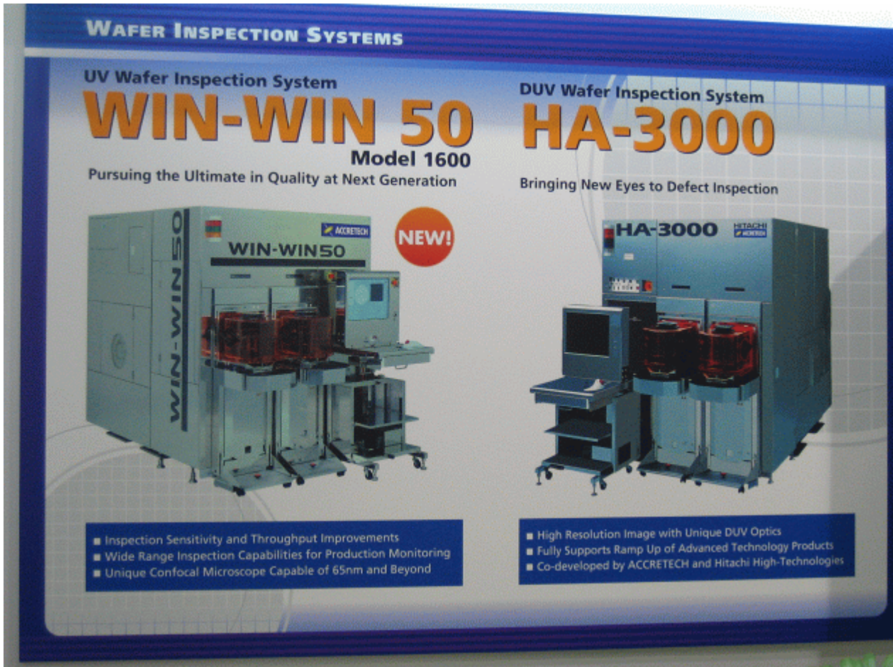
[그림15] 히다찌의 DUV를 사용하는 웨이퍼 검사장비
