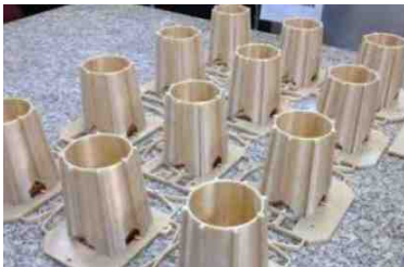
<그림 2-9> ULTEM 9085 소재의 인공위성 부품
