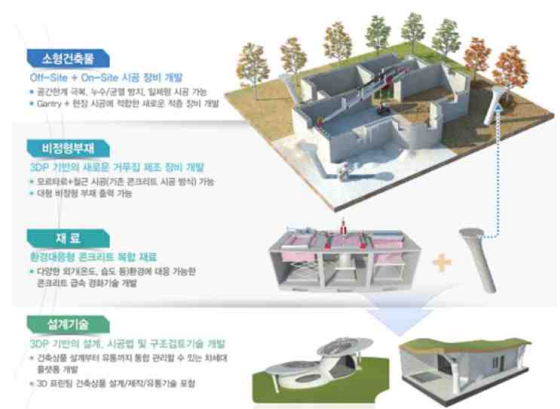
<그림 2-2> 3D 프린팅 건설 대표기술 개념도(KICT 연구단)
