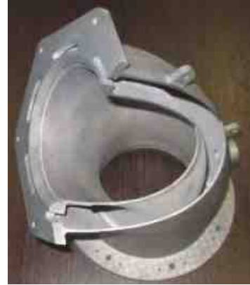
<그림 2-8> Airbus사-AM기반 연료 커넥터 무형
