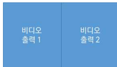
그림 24. 프로젝터 한 대가 출력하는 화면 구성. 두 개의 1920×2160 출력을 하나의 3840×2160 출력으로 조합한다.
