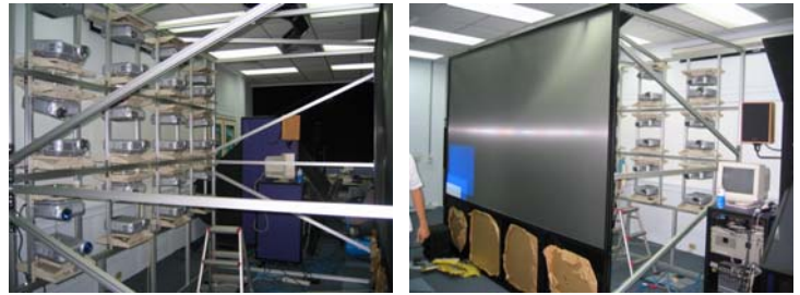
[그림 2-3] 프로젝터와 스크린을 이용한 출력장치(NCHC)
