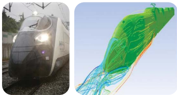
▲ 해무의 머리 모양은 열차가 빠르게 달릴 때 받을 수 있는 공기 저항 등을 계산해 만들어졌다. 사진 제공 : 한국철도기술연구원
