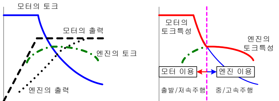
<모터와 엔진의 토크 및 출력비교, 하이브리드 작동원리(우측그림)>
