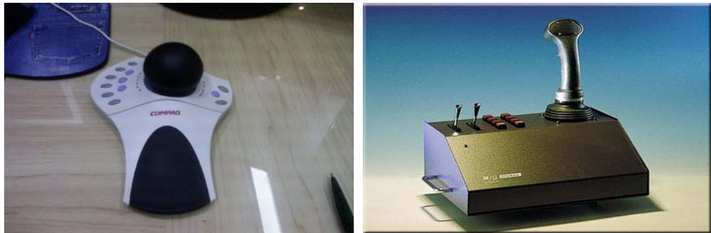
[그림 2-8] trackd와의 연계에 문제가 있었던 SpaceBall4000(좌)과 교체 설치한 FlyBox(우)
