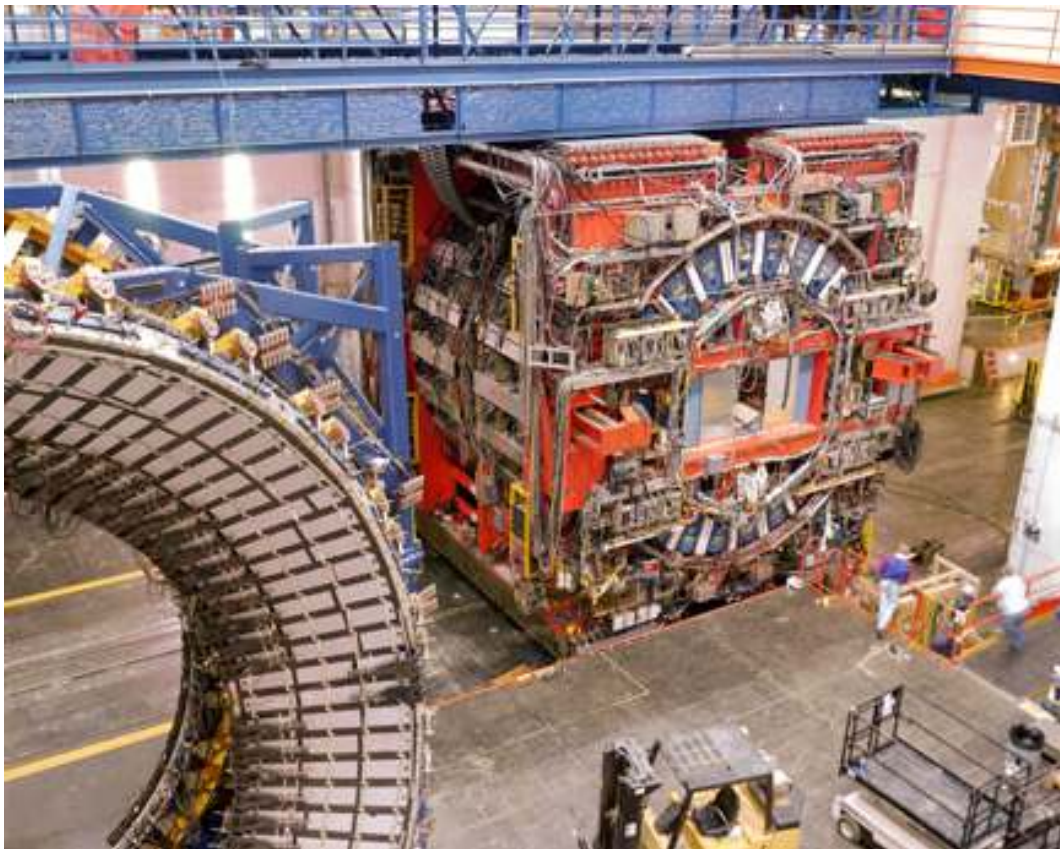
그림 10 CDF Detector at B0 point of Tevatron
