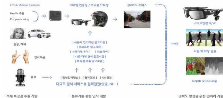
<그림 3-27> (주)모비넷피아 스테레오 카메라 기반 객체 검출 및 인식기술
