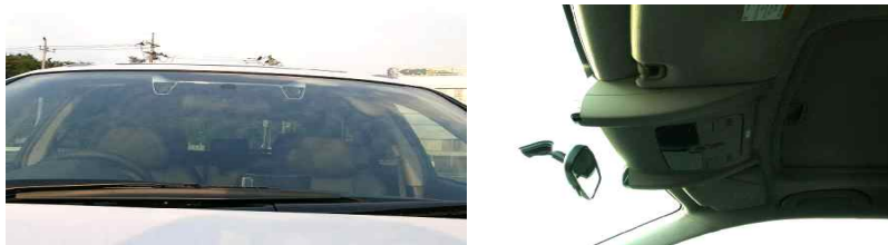
<그림 2-7> 차량에 탑재된 스테레오 카메라 시스템
