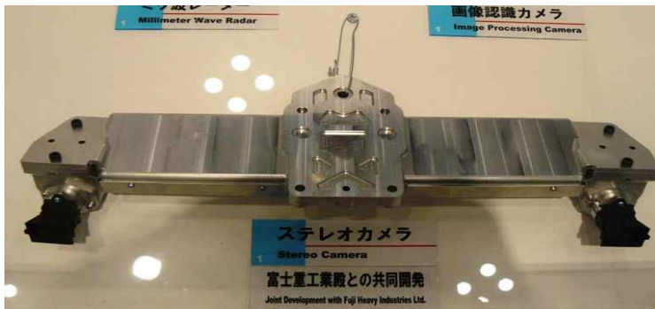
<그림 3-19> 히타치 차세대 ADAS 스테레오 카메라
