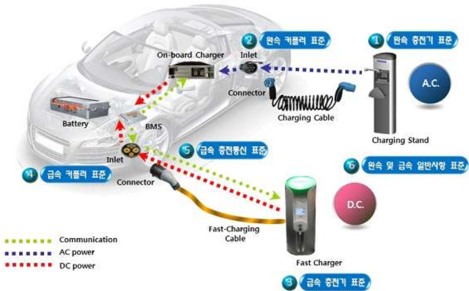
<그림 5-1> 전기차 충전의 구성 및 개념 (출처: 스마트그리드표준화포럼, 2012)
