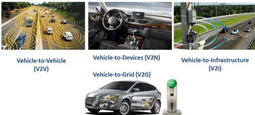
<그림 2-1> V2X 기반의 새로운 차세대 차량 통신 기술 개념도 (출처: 미국자동차공학회, 2012.5)
