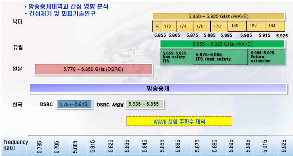
<그림 3-2> WAVE 주파수 배정 현황 (출처: WAVE 통신 및 서비스 현황, 오현서(ETRI), 2012)
