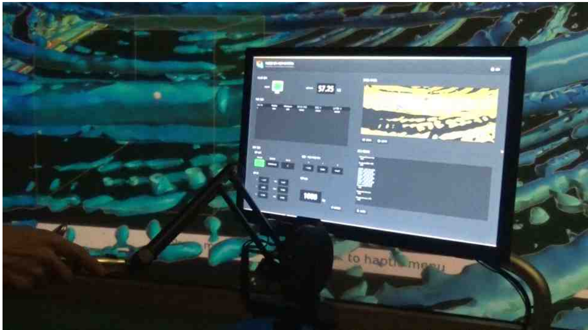
[그림 5-6] "Notification" 메시지의 정보를 이용해서 햅틱 프로브를 VR 화면에 출력한 모습 (좌측 상단 하얀색 sphere)
