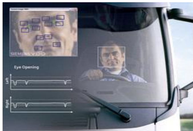
<그림 2-5> 1세대 2D 운전자 상태 감시 시스템
