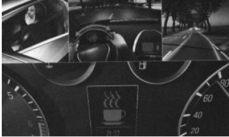
<그림 3-14> 보쉬의 운전자 졸음감지 시스템
