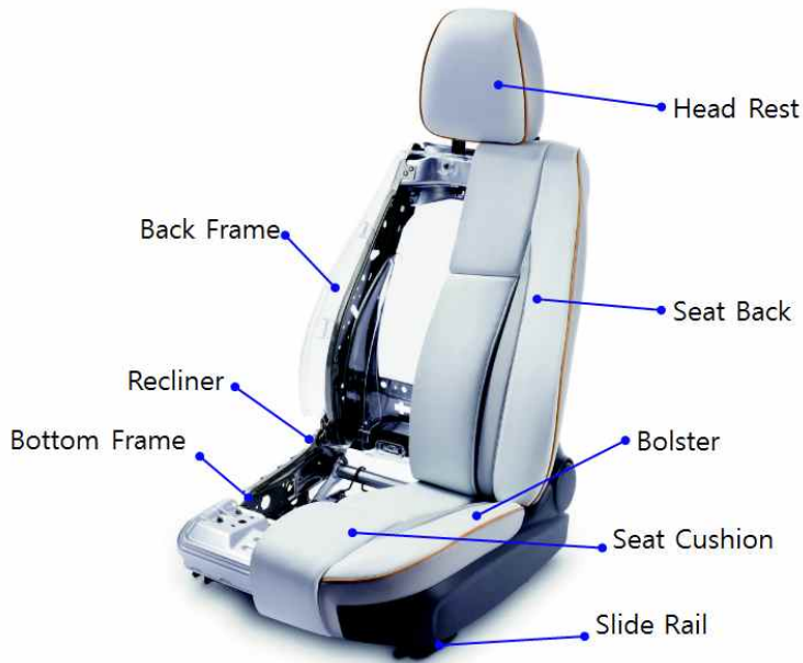
<그림 2-1> 자동차 시트의 구성
