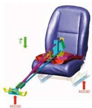
<그림 3-55> 르노의 생산 시트 유효성 파악을 위한 해석
