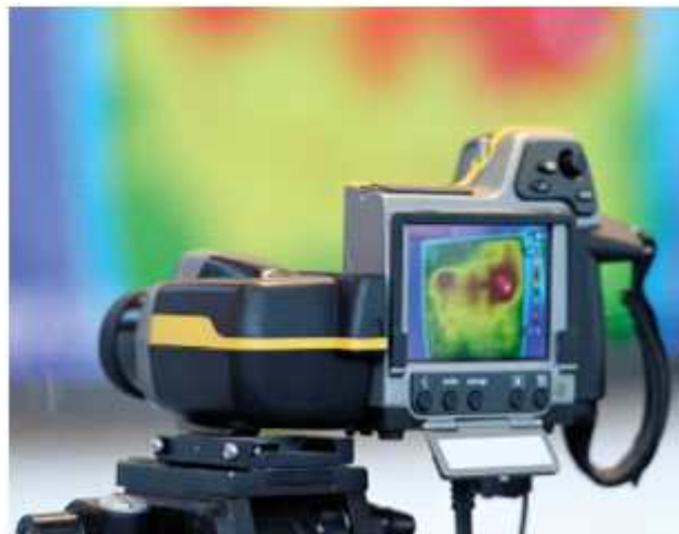
[그림 19] 비파괴 원자재 검사를 위한 서모그래피
