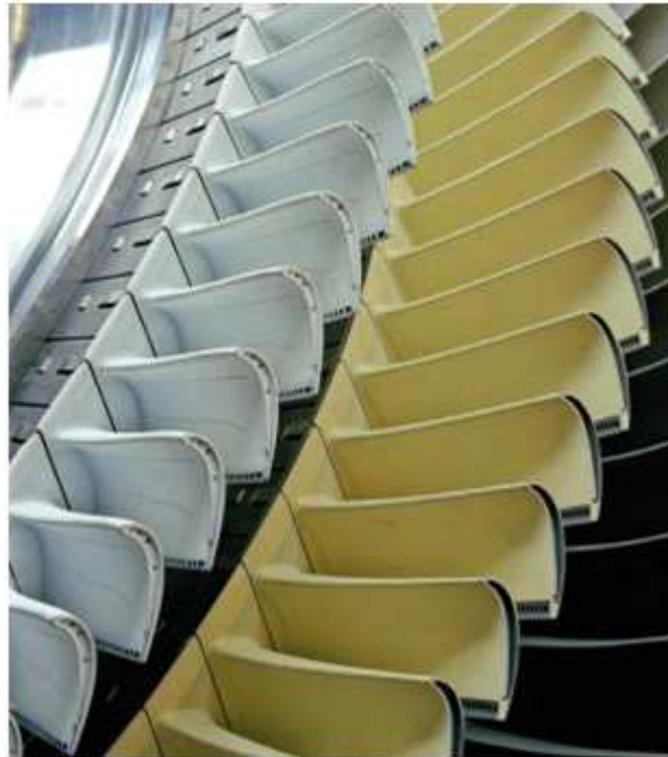
[그림 20] 고열 스트레스 방지 열 차폐 코팅 내부 냉각 터빈 블레이드
