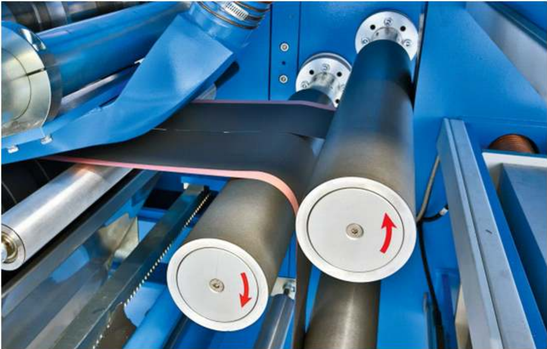
[그림 23] 배터리 제조: 효율적인 소재사용을 위한 전극 밴드의 종단(longitudinal cuts)
