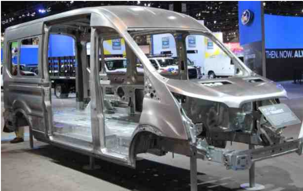
[그림 21] 고장력을 이용한 Ford Transit Body Structure
