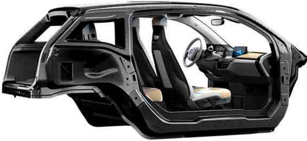
[그림 18] BMW i3 CFRP Body Frame
