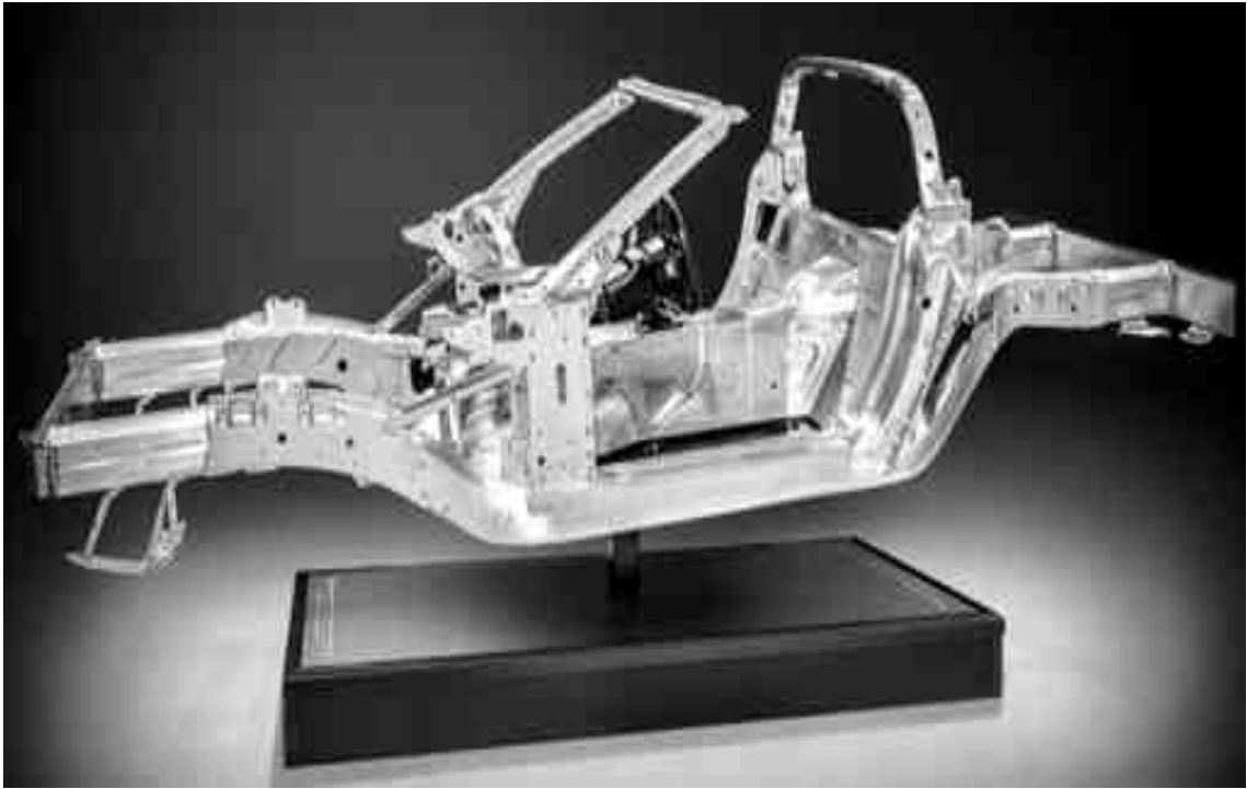
[그림 23] Corvette Stingray 알루미늄 프레임
