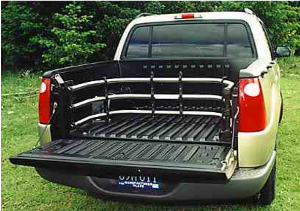
[그림 44] SMC 공법으로 제작된 Ford의 화물 적재함
