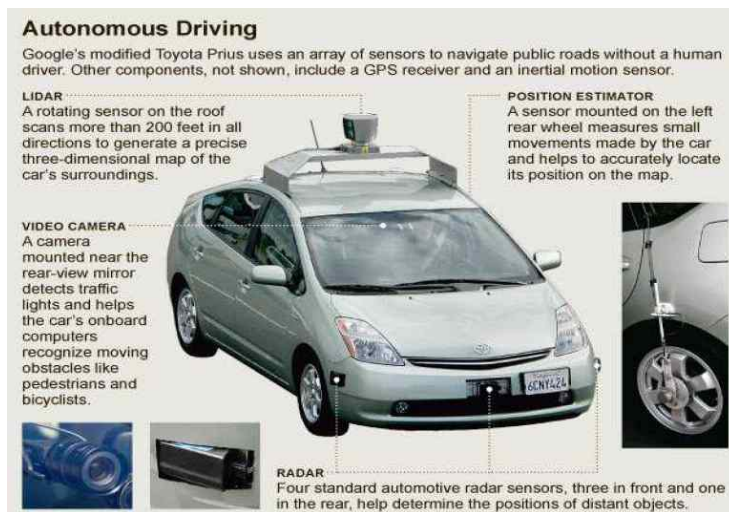
<그림 2-1> 구글카의 주요 장치
