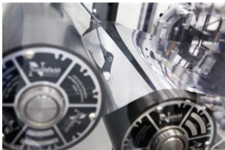
그림 3-16. SoloPower Roll-to-Roll 제조장치
