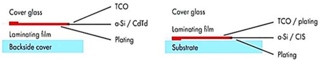
그림 3-11. 박막태양전지의 구조; (좌) Superstrate구조, (우) Substrate구조
