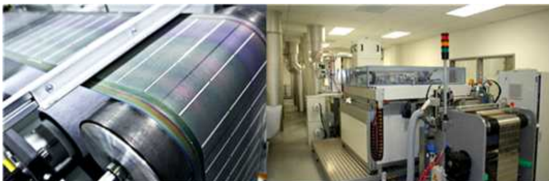
그림 3-13. 플렉시블 CIGS박막태양전지 공정기계; (좌) Solopower, (우) Global Solar
