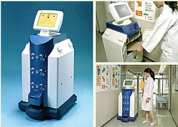
일본 마츠시타전공에서 개발한 HOSPI(X선 필름, 검사 대상 물체, 약, 진료기록카드 등을 운반하는 병원내 자율 반송 로봇)
